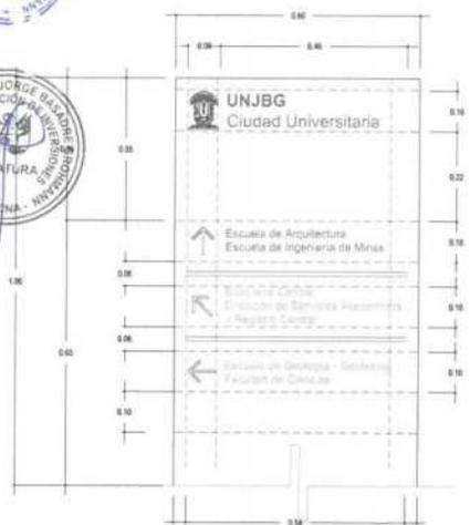
**SECCION SUPERIOR DE MODULO DIRECCIONAL
